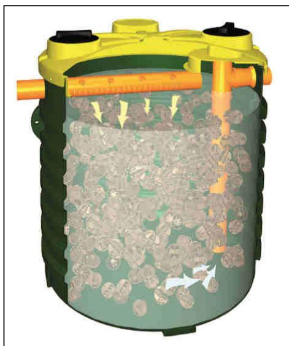
Figura 1. Esempio di filtro percolatore (Immagine tratta da Scheda tecnica e manuale di uso e manutenzione – Filtri percolatori anaerobici – ROTOTEC s.p.a. - https://rototec.it/ )
