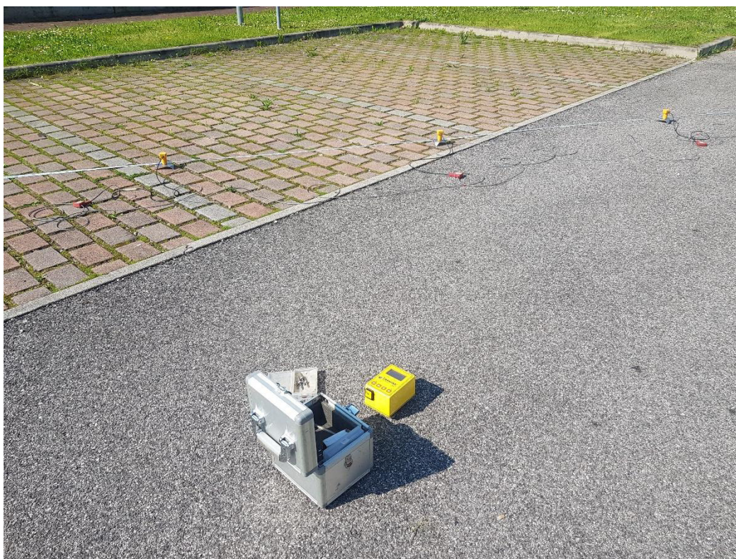
Foto n.6 – Esecuzione indagine sismica H.V.S.R.
