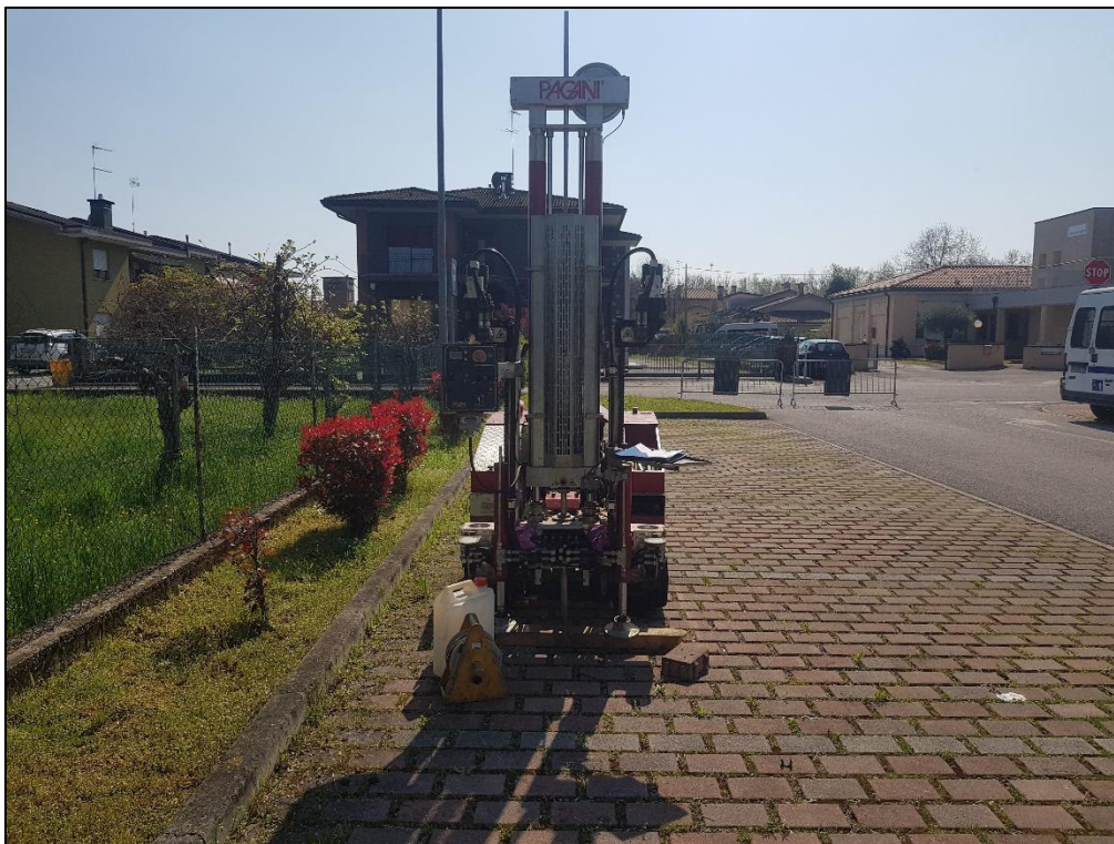
Foto n.5 – Esecuzione prova penetrometrica dinamica superpesante (DPSH5).
