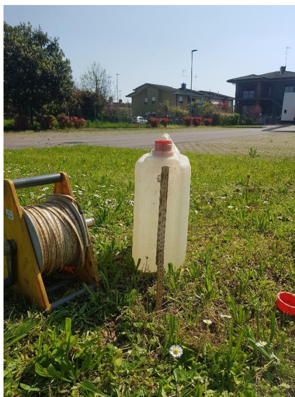
Foto n.8 – Esecuzione prova di permeabilità K1
