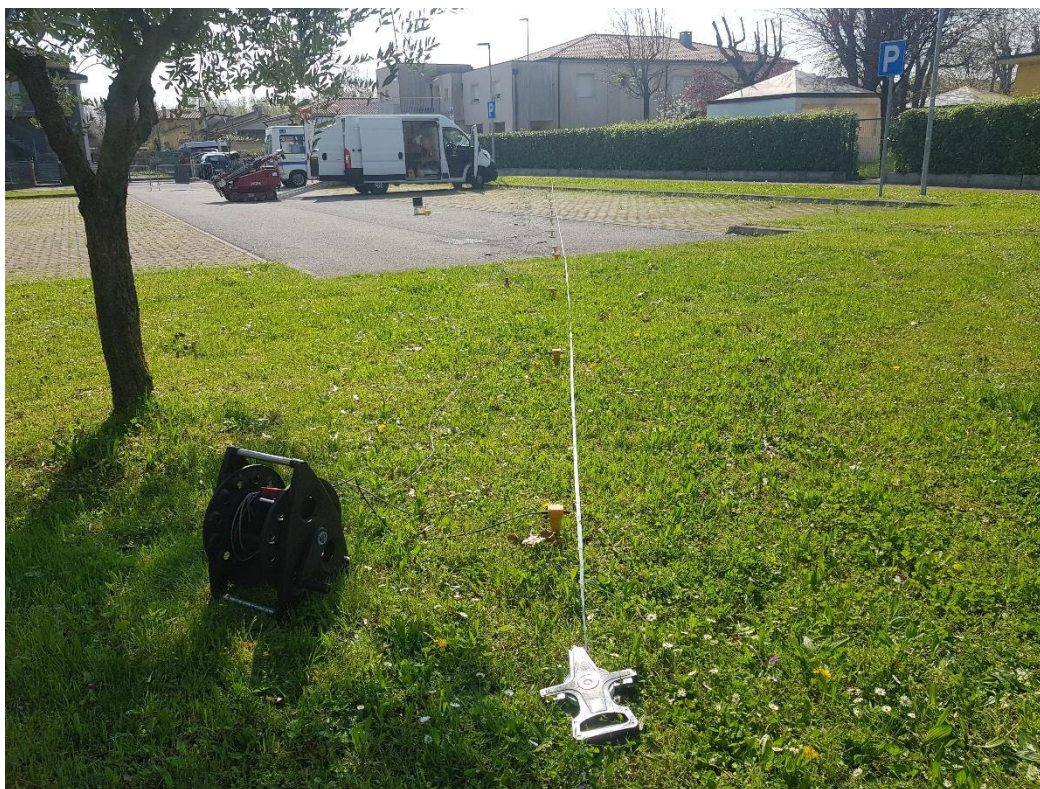
Foto n.7 – Esecuzione indagine sismica Re.Mi.
